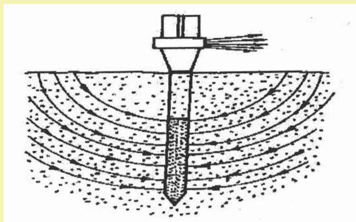
**4)** Ora l’aria viene lentamente tirata verso il basso per raffreddare il grano ad una temperatura di sicurezza. Normalmente 36 ore di funzionamento sono sufficienti per ottenere il risultato desiderato.
