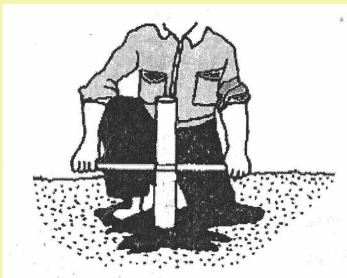
**2)** Quando il tubo è completamente immerso nel grano, il grembiule di plastica deve essere collocato sopra il tubo in modo che la superficie intorno al tubo venga sigillata. Questo impedisce che l’aria penetri verso il basso direttamente alla sezione perforata, senza che il grano sia ventilato. Inoltre il dispositivo così ha un raggio di lavoro più ampio.
