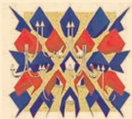
Esempio di modulo con discesa del prodotto a gravità con movimento a correnti miste incrociate e flusso d'aria calda in controcorrente.
